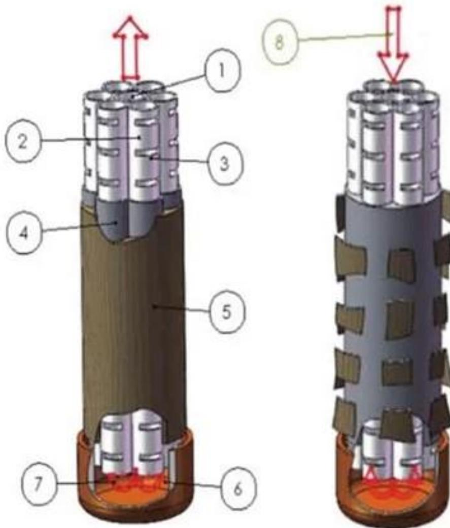
1. Zentralrohr klares Flüssigkeitserfassungsrohr
