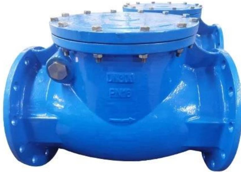
**Válvula de retención oscilante** está montado con un disco que se balancea en una bisagra o eje. El disco se balancea el asiento para permitir el flujo hacia adelante y cuando se detiene el flujo, el disco vuelve al asiento para bloquear el flujo inverso.
