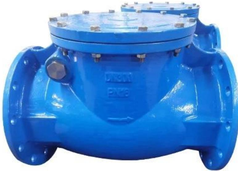
La válvula de retención de swing está montada con un disco que se balancea en una bisagra o eje. El disco se balancea el asiento para permitir el flujo hacia adelante y cuando se detiene el flujo, el disco vuelve al asiento para bloquear el flujo inverso.
