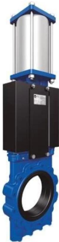
双向突耳对夹式刀闸阀：“整体”一体式铸铁机身，不锈钢闸门，有两个胶套。流速高和阻力低。结构长度设计依据CMO标准。多种阀座材质可定制。
