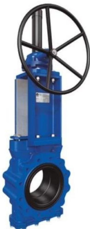
GH系列刀闸阀定义为高压LUG型刀阀（20Bars或以上）。它具有坚固的设计，可在高压下以最佳性能工作，再生套管由精心研究的高强度材料制成，因此保证了采矿服务的卓越性。适用于双向操作，对称机身，可根据要求提供高达52Bars（780PSI）的工作压力。
