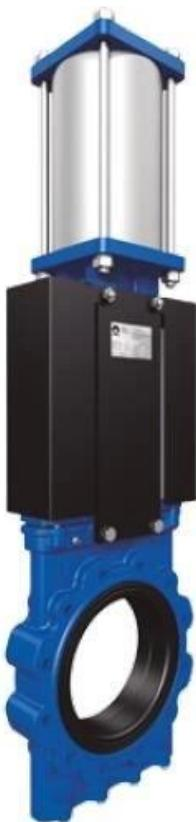
双向突耳对夹式刀闸阀：“整体”一体式铸铁机身，不锈钢闸门，有两个胶套。流速高和阻力低。结构长度设计依据CMO标准。多种阀座材质可定制。
