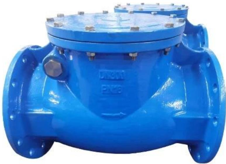
[\*\*Качающийся проверка клапана\*\*](#) монтируется диском, который качается на шарнире или валу. Диск снимается с сиденья, чтобы позволить передний поток, и когда поток останавливается, диск поворачивается обратно на сиденье, чтобы блокировать обратный поток.
